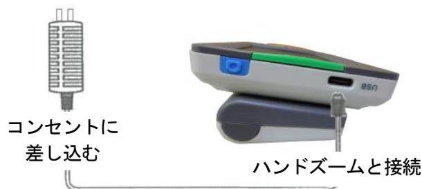
「DC IN 端子」に AC アダプタを接続し、コンセントに差し込みます。充電中はバッテリーインジケータが赤く点灯します。赤のランプが消えたら充電完了です。\*初めて使用する際は充電をしてください。
