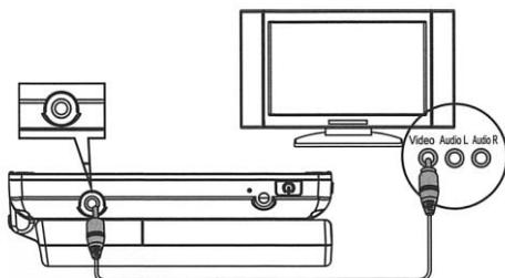
付属のテレビ接続用ケーブルを差し込み、外部画面に出力できます。テレビ側は黄色のビデオ端子につなぎます。\*テレビ接続時、本機画面は消灯します。
