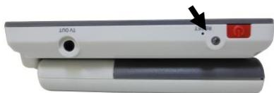
注意事項：電源が切れている状態で「カメラボタン」と「電源ボタン」を同時に押して電源を入れてしまうと、再度電源を入れてもフリーズ状態になりボタンが利かなくなります。
